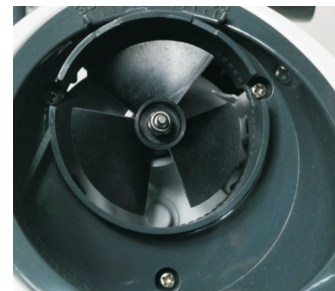
8.3: Emboîtez à nouveau le clapet après avoir nettoyé la turbine.
